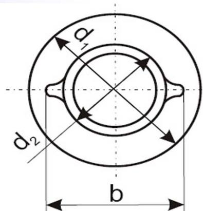
Предназначена для защиты изоляции проводов и кабелей от механических повреждений об острые кромки торцов труб диаметром от 15 до 82 мм или других конструктивных отверстий при прокладке в трубах, вводах в электрощиты, ящики управления. Климатическое исполнение УХЛ2
