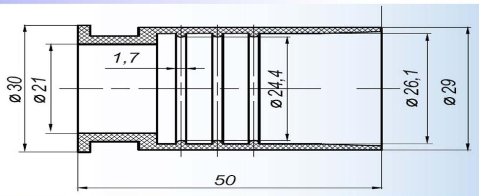
Предназначена для уплотнения мест ввода труб в коробки и для скрытой проводки, применяемой при крупнопанельном домостроении. Климатическое исполнение У3
