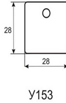
Предназначена для маркировки проводов, кабелей, труб, металлоконструкций и т.д. Поверхность бирок хорошо подходит для нанесения надписи. Климатическое исполнение У3;5
