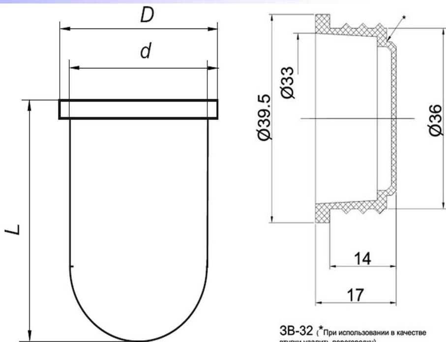
Предназначена для временного закрывания концов труб или других конструктивных отверстий с целью предохранения от попадания в них строительного мусора. Климатическое исполнение УХЛ2
