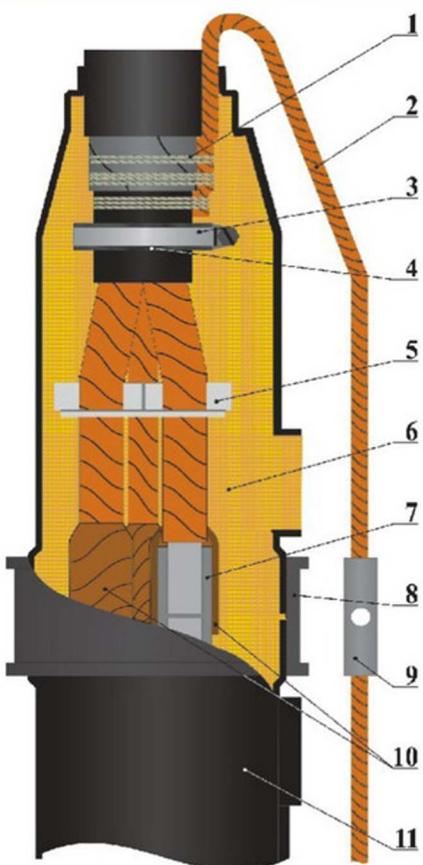
1. Бандаж из проволоки, закрепляющий провод заземления.
