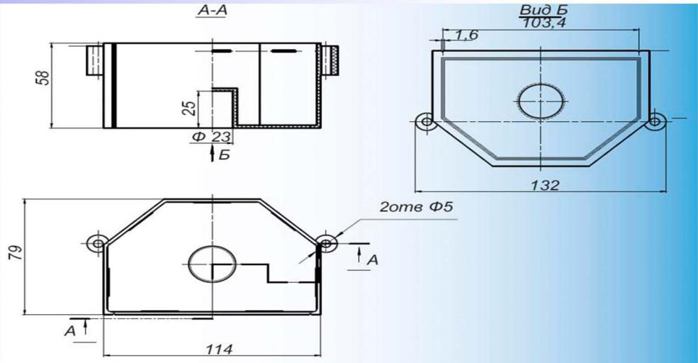
Предназначена для размещения узлов соединения проводов при переходе электропроводки из панели перекрытия в стеновую панель.
